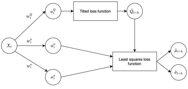
**Figure 5: Simple Version of the DQPR**
