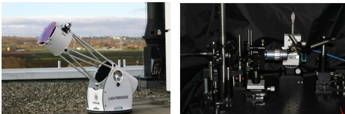
Фигура 3.12: (ляво) – Фотография на установката за улавяне на Слънцето, базирана на Dobsonian телескоп. Вижда се и 12-инчовия интерференчен филтър; (дясно) – Фотография на изхода на влакното.
