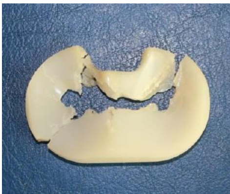
фигура 15: Фрагментиране на полиетиленов инсърт на колянна ендопротеза след 16 години експлоатация.
