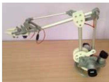
Фигура 3.12. Модифицирана версия на uStepper Robot Arm, позволяваща използването на постоянно токови мотори
