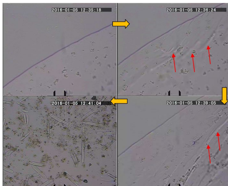
Фигура 20. Микроскопски изображения на изсушени капки от супернатант. Разликите в размера на им се дължат на малки разлики в обема на отложените капки и на различното разтичане на разтворите на ПАВ. Марка: 400 \mu\text{m} .
