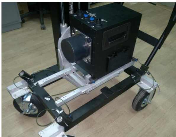
Фиг. 2.4.1. Подвижна полупроводникова система за измервания на проби и измерване на място ( in-situ ), използвана за сравнителни измервания със системите за въздушно обследване
