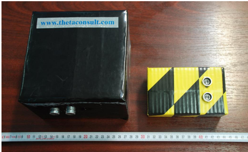
Фиг. 6.2.3. Броячната детекторна система използвана в предишните експерименти (в дясно) до спектрометричната използвана в настоящия експеримент (в ляво)
