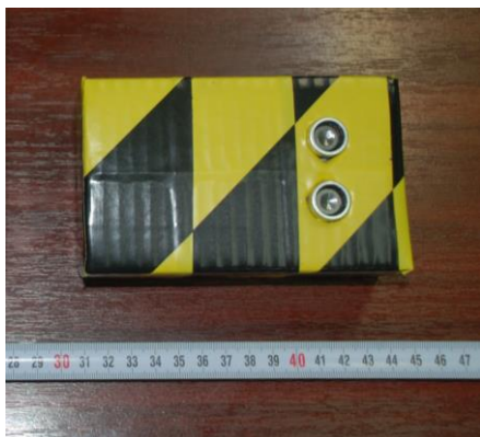
Фиг. 5.2.2.3. Сглобена броячна детекторна система с детектор от CsI, GPS приемник, ултразвуков далекомер и автономно захранване
