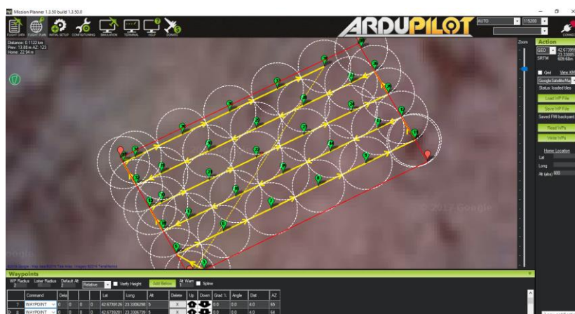
Фиг. 5.3.1. Летателен план, изготвен със софтуера MissionPlanner
