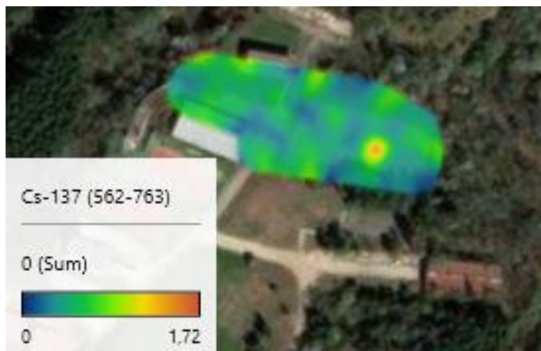
Фиг. 6.4.4. Предварителен оглед на резултатите, във вид на карта, генерирана с Microsoft Excel, за ROI на ^{137}\text{Cs} . Вижда се предполагаем точков източник, но възможностите на софтуера не позволяват постигане на по-ясна карта
