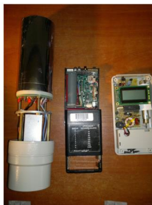
Фиг. 5.2.1.1. Част от сцинтилационните детектори участващи в сравнението (в ляво) и цели детекторни системи използвани в дозиметри (в дясно).
