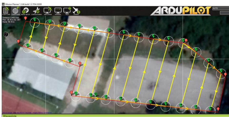
Фиг. 6.3.2. Визуално представяне на летателния план за гама спектрометричното обследване
