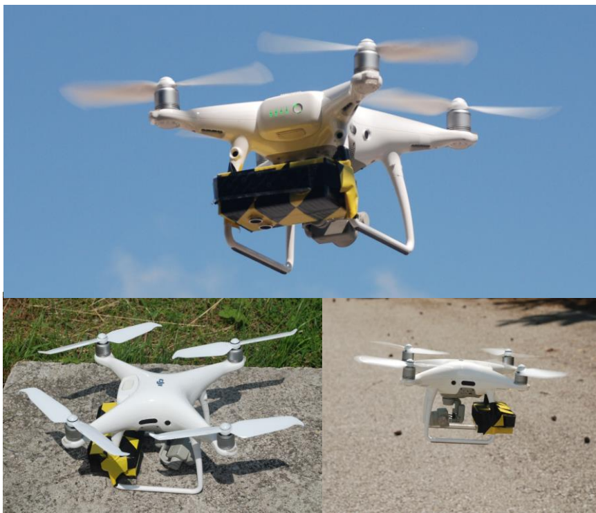
Фиг. 5.2.3.1. Квадрокоптер DJI Phantom 4 PRO с броячната сцинтилационна детекторна система
