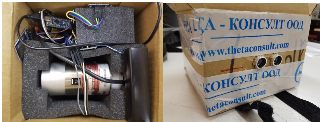
Фиг. 6.2.2. Снимки на детекторната система със сцинтилатора използван за спектрометричното картографиране
