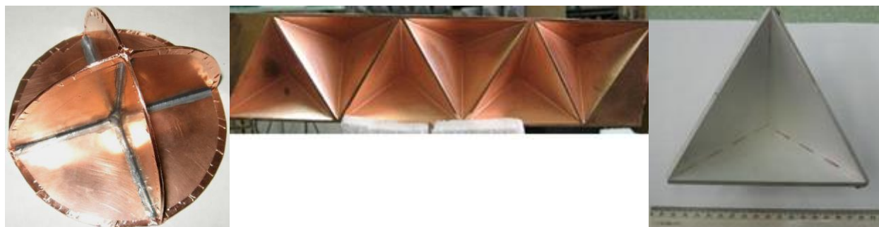
Фиг. 7.1.1.1. Преден отражател (обект 2) от тип “кръстачка”, съставен от четири трихедрала (вляво); страничен отражател (обект 1), съставен от шест трихедрала, подредени в редица (в средата) и референтна мярка за ЕОП = 2 \text{ m}^2 (вдясно)
