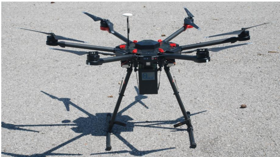
Фиг. 6.2.4. Хексакоптер DJI Matrice 600 използван за гама-спектрометричната карта
