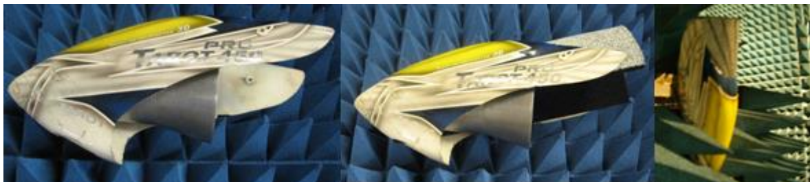
Фиг. 7.1.2.10. Предна част от БЛС с екран и със и без градиентен погълтател; отражателната способност е измерена в безехова камера
