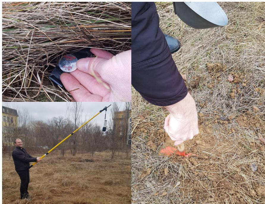
Фиг. 1.4.1. Поставяне на източника под слой трева (горе, в ляво) и под 10 cm почва (дясно). Измерване с преносим радиометър на височина 2 m (долу, в ляво).
