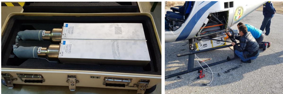
Фиг. 3.2.1. Използваната апаратура за въздушно - гама спектрометрично картографиране SPIR-IDENT MOBILE, произведена за такива цели от Mirion Technologies
