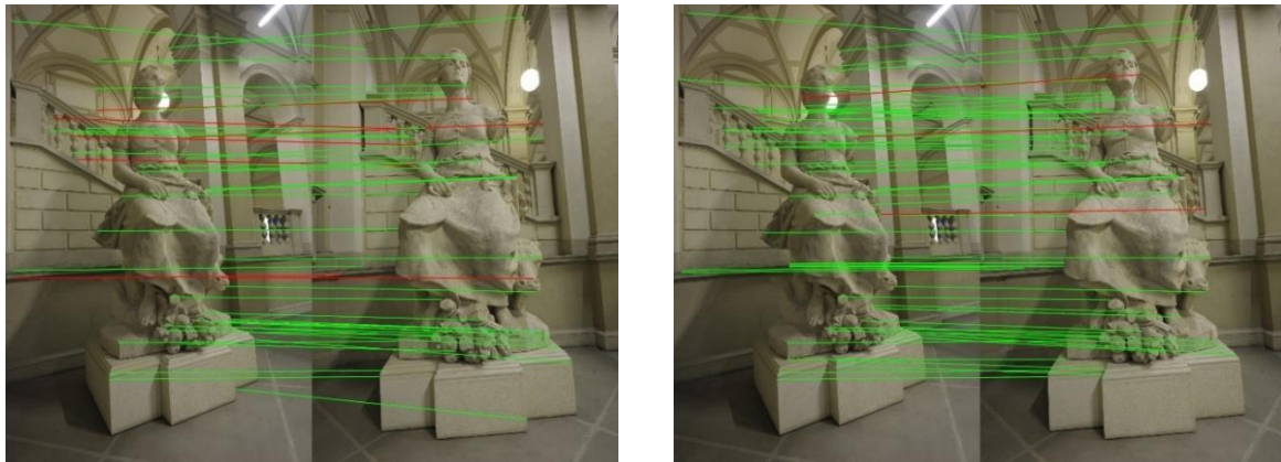
Фигура 16. Сравнение на OmniGlue [45] (вляво) и OmniGlue + Self-TM Base (вдясно) при откриване на съвпадения между ключови точки в изображение с различна модалност от данните за обучение и на двата модела. За целта на визуализацията, съвпаденията с висока точност не са визуализирани, за да бъдат видими грешките.
