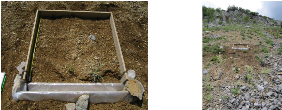
Фиг. 34. Площадка-уловител за мониторинг на делувиален смив в участък KS1
