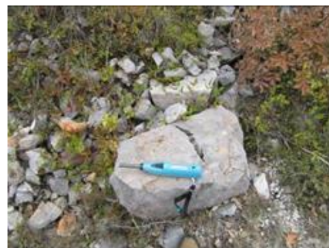
Точка 495 – опробване със Schmidt hammer (type N)
