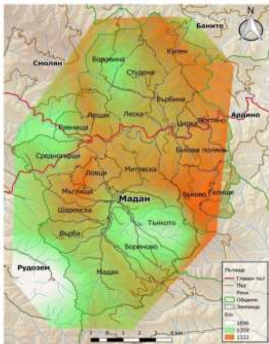
Фиг. 3. Пространственото разпределение на средномесечното количество слънчева енергия, произведена от 1kW(p) фотоволтаична инсталация в община Мадан при наклон от 32°
