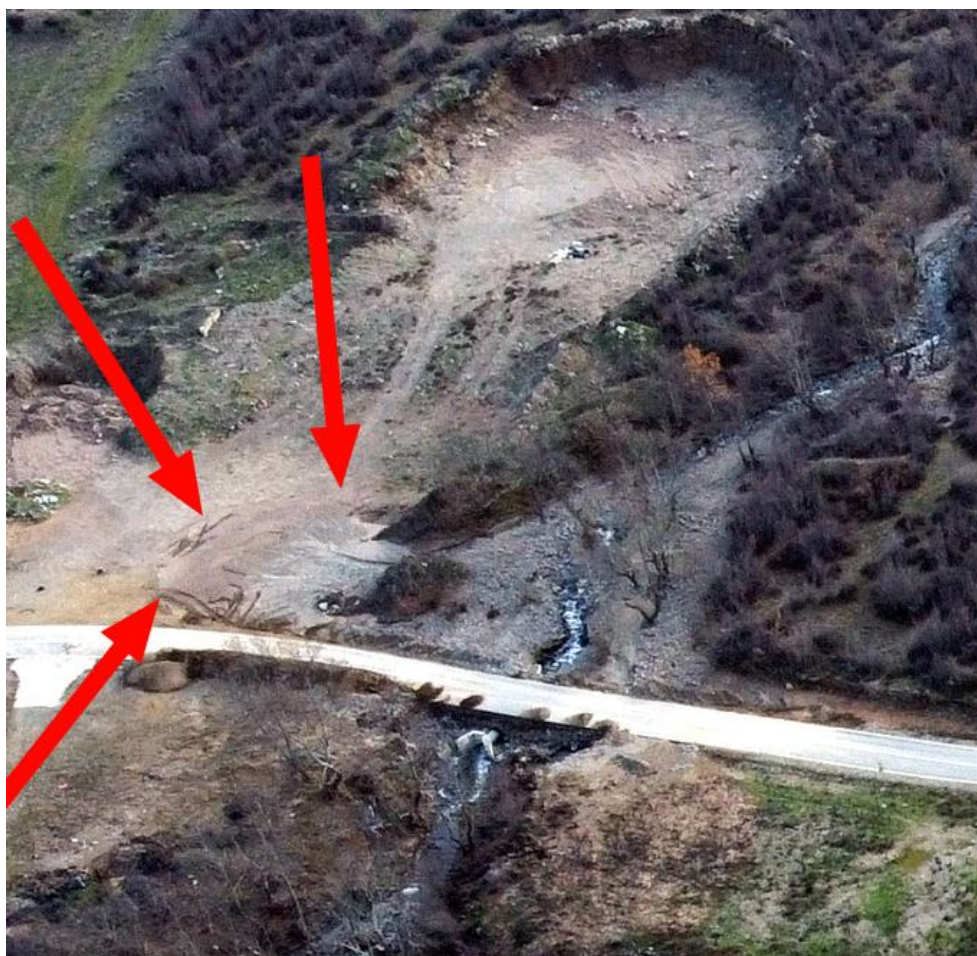
Фиг. 5. Оформен алувиален конус на мястото на пресичане на речна долина с пътя гр. Петрич – с. Беласица. Дисталните части на конуса са изградени от пясък, гравий и глини; маркирани са с червени стрелки. Поглед към ЮИ, широчината на пътното платно е 6 т.
