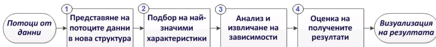
Фигура 17. Блок схема на методология за извличане на зависимости от ПД
