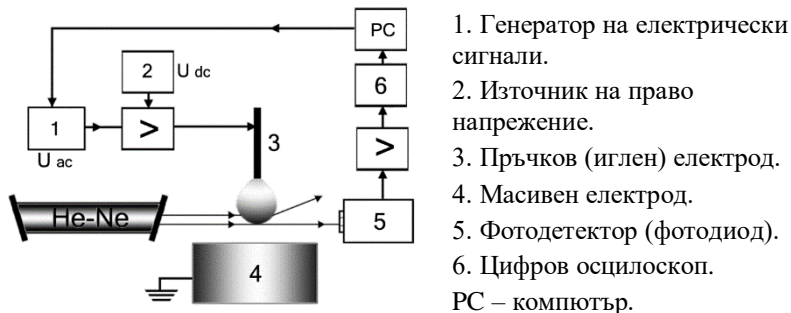
Фиг. 2.2. Принципно схема на експериментална установка за електрическо възбуждане на механични осцилации на висяща капка
