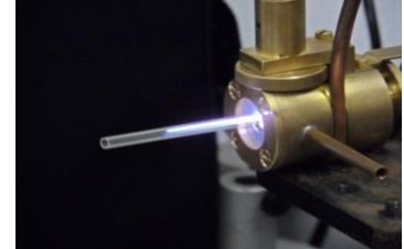
Фиг. 2.3 (б) Разряд около диелектричен цилиндър
