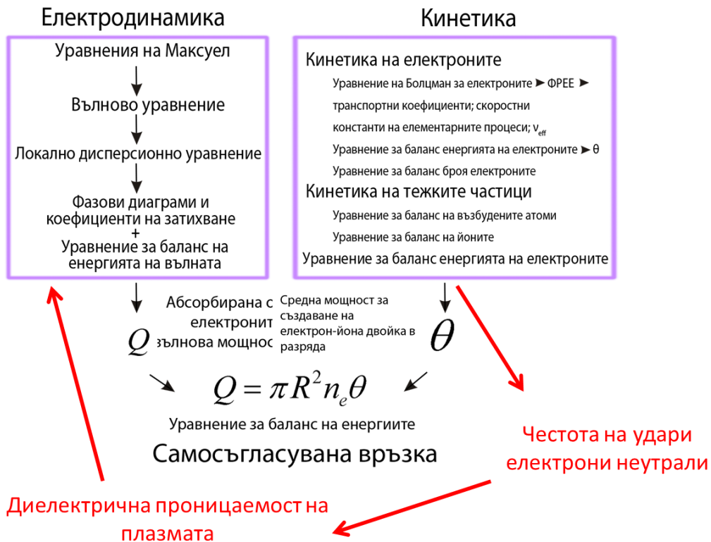
Фиг. 3.4 Схема на основните уравнения, самосъгласуваната връзка на кинетичната и електродинамичната части на модела
