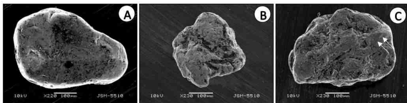
Фиг. 4.4. Повърхностни характеристики на платиновите зърна: А – дисквидно платиново зърно GOP4 с голям брой ямички по повърхността му; В – ръбесто зърно RD1P2 с грапава повърхност и удължени плитковидни вдлъбнатини, запълнени с детритусни минерали; С – платиново зърно DV2P1 с повърхност показваща различен химичен състав.
