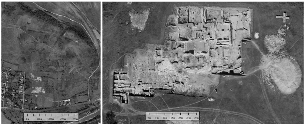
Фиг. 6. RGB ортофото-карта на НАР „Деултум“ (ляво) и фрагмент в оригинална ПРС (0.069 m)
