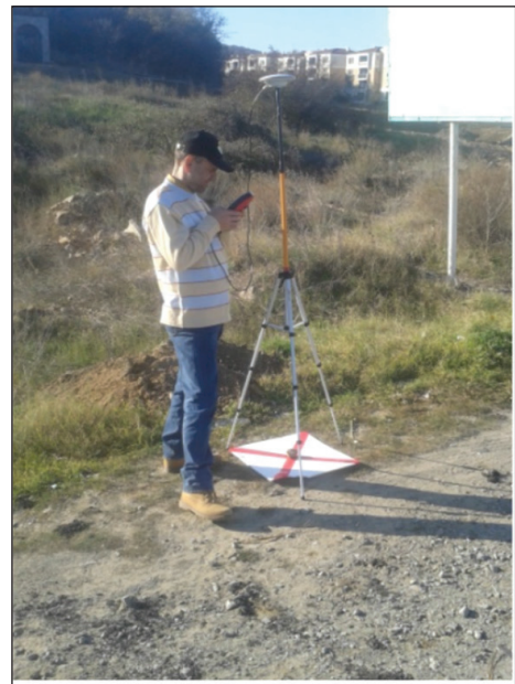
Фиг. 3. Прецизно заснемане на координатите на наземна контролна точка
