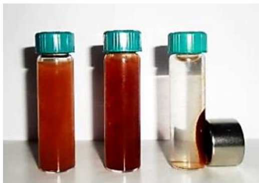
Фигура 33. Демонстрация на магнитна сепарация на магнитно-модифицирани калъфи: външен изглед на водна суспензия от нативни калъфи от Leptothrix (вляво), суспензия от калъфи след магнитна модификация с ферофлуид (в средата) и демонстрация на магнитна сепарация на магнитно-модифицираните калъфи (вдясно).
