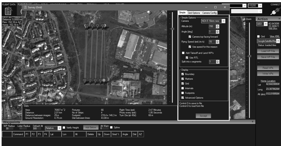
Фиг. 3. Конструирани на примерен летателен план за ортофотозаснемане
