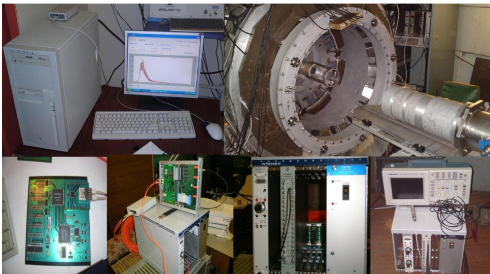
Фигура 2.18. Експериментална установка на канал №12 на реактор ИБР-2М. Монтиран детектор с прилежащата към него част от системата (един 32 канален блок дискриминатор) за събиране на данни.
