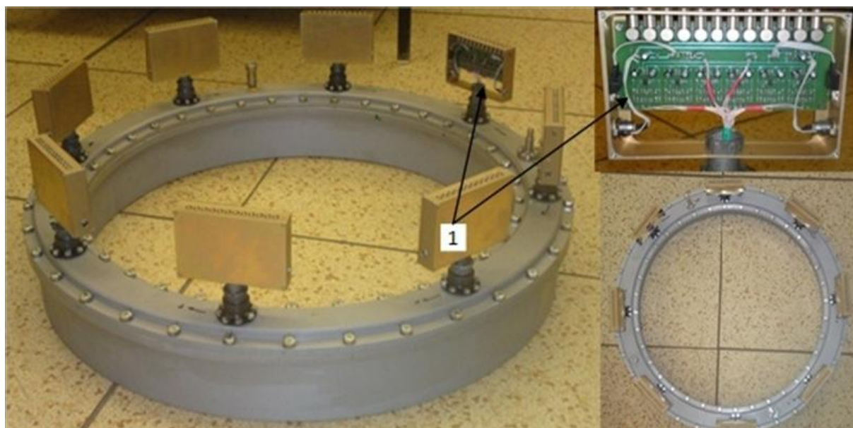
фигура 2.14. 2л Секционен детектор (16 x 6) на топлинни неутрони с монтирани 8 дванадесет канални усилватели-формирователи (1) (по един на всеки две рамки).
