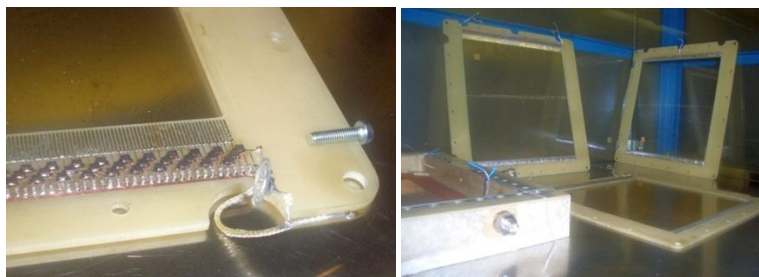
Фигура 2.2 Линията на закъснение върху катодна рамка и вид на детектора с рамките в разглобен вид.
