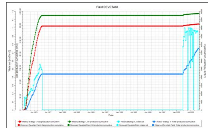
Фиг. 4.3.4. Графика на кумулативния добив на кондензат, газ и вода (Observed) по години за находище Деветаци, заредени в модула Историческа стратегия (History Strategy) в софтуерната платформа Petrel.
