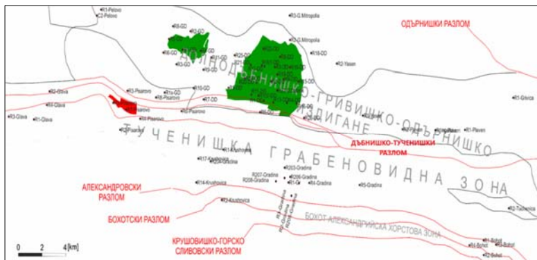
Фиг. 1.3.1. Тектонска схема в зоната на изследване с локализация на Писаровското газо-кондензатно находище и нефтени находища Горни и Долни Дъбник (по Атанасов и Боков с допълнения).
