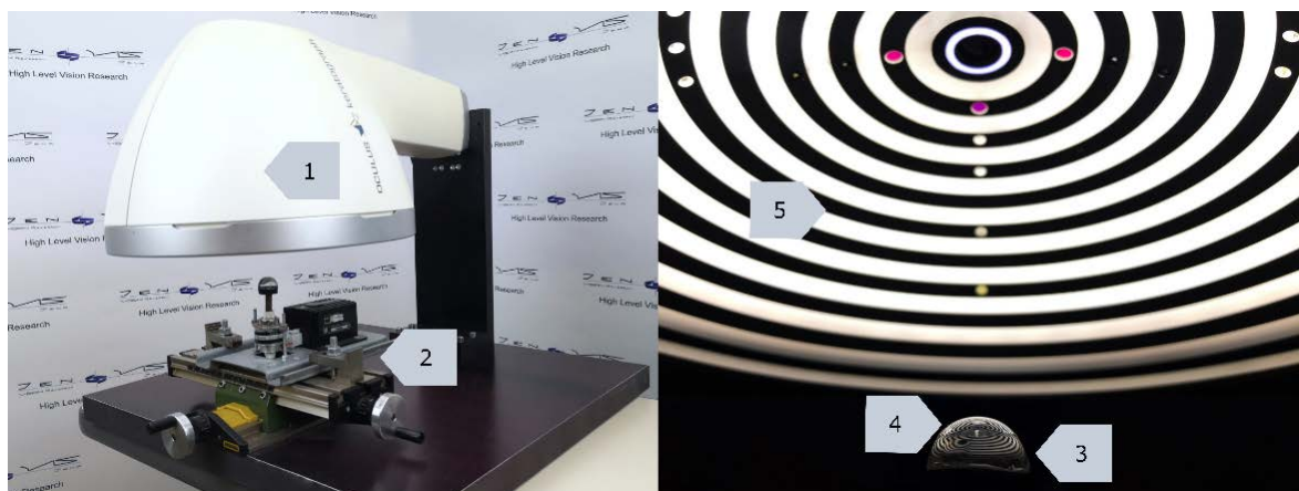
Фиг. 8 Измервателно устройство без корпус (вляво) и мека контактна леща на платформата под диска плачидо (вдясно): 1 = хоризонтално монтиран Кератограф 5M (климатичният корпус не е показан); 2 = регулируема x-y-z-платформа; 3 = измервателен пулт; 4 = контактна леща; 5 = бял осветен пръстен
