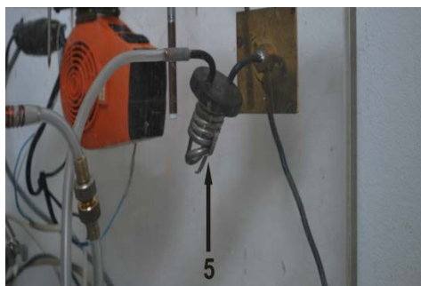
Фигура 49. Поглед към входния теплообменник.
