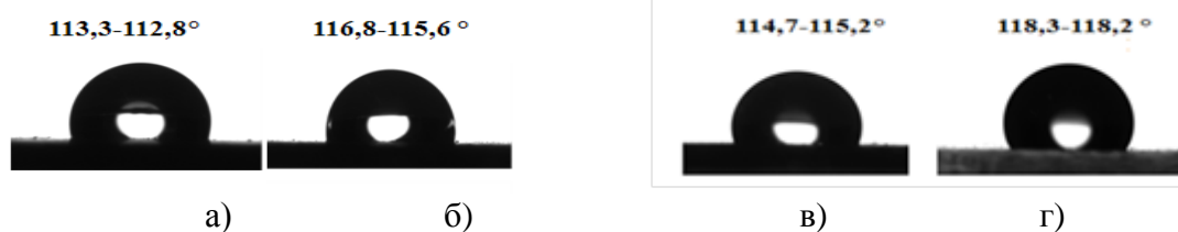
Фигура 66. Измерване на контактен ъгъл ( \theta ) на тънки филми от ZnO получени по зол-гелна технология, отложени върху лабораторно стъкло а) и керамична подложка б); наножици от ZnO отложени върху лабораторно стъкло в) и керамична подложка г).
